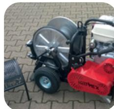
Die Zugkraftaufzeichnung erlaubt die Darstellung und Protokollierung der gezogenen Kräfte und ermöglicht durch die Messung ein automatisches Abschalten der Winde bei Überschreitung der vordefinierten Werte.
