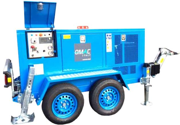
Die **Kabelziehwinde KZW-H 100** besticht durch ihre leichte und kompakte Bauweise, jedoch mit einer spektakulären Zugkraft von bis zu 100 kN. Zum Arbeitseinsatz wird lediglich die abschließbare Klappe zum Bedienpult geöffnet und die Winde im Boden verankert. Umständliche Rüstzeiten entfallen.
