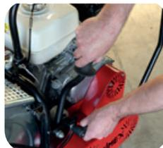
Wenn mit unterschiedlichen Seildurchmessern gearbeitet wird oder das vorhandene Seil durch ein weiteres verlängert werden muss, entfällt durch einfaches Auswechseln der Haspel ein aufwändiges Umspulen. Hierzu bieten wir selbstverständlich zusätzliche Ersatzhaspel als Erweiterung an.
